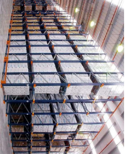
Fotografía descriptiva del sistema DRIVE-IN . Las características pueden ser diferentes a las del Presente proyecto
